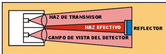
Figura 94. Haz de Sensor Retrorreflector Efectivo
